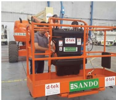
Se trata de un sistema de seguridad activo, que señala y alerta a los responsables de la obra ante la falta de sujeción del trabajador o ante el riesgo de colisión, y que emplea sensores móviles, radiofrecuencia y ultrasonidos, resistentes a las inclemencias medioambientales y agresiones externas.
