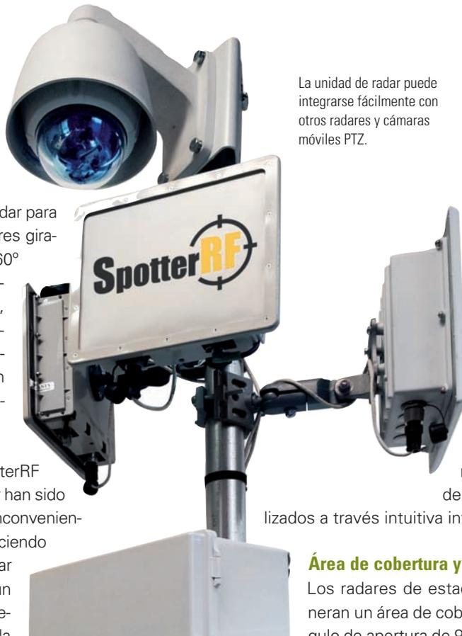
La unidad de radar puede integrarse fácilmente con otros radares y cámaras móviles PTZ.
